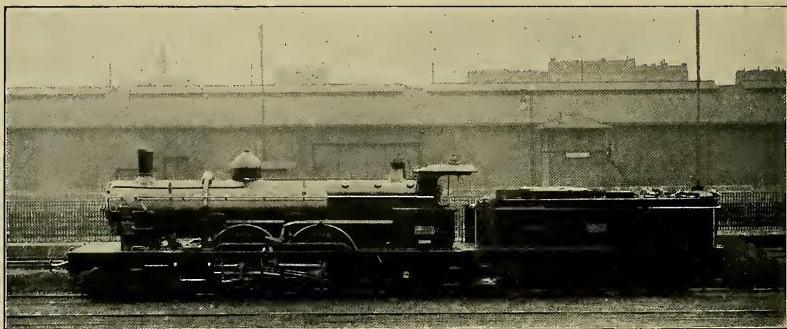
Locomotive compound, à quatre cylindres, type « Atlantic, » de la Compagnie du Nord.
